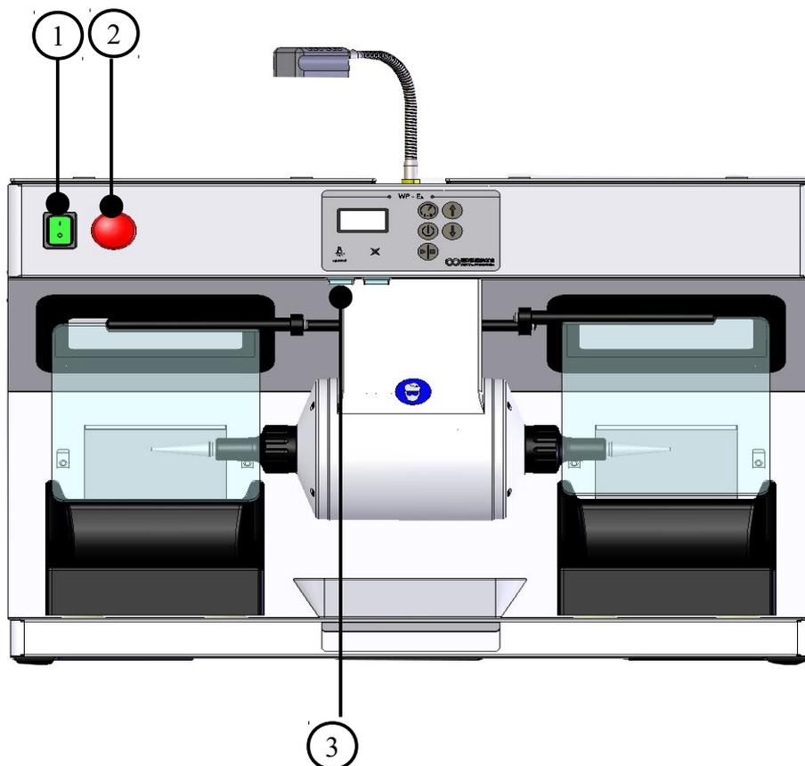
Die **WP-Ex 3000 II** wird über den Hauptschalter eingeschaltet. Die Motordrehzahl wird über die Pfeiltasten gesteuert. Die Absaugung und der LED-Spot können manuel ein- und ausgeschaltet werden.
