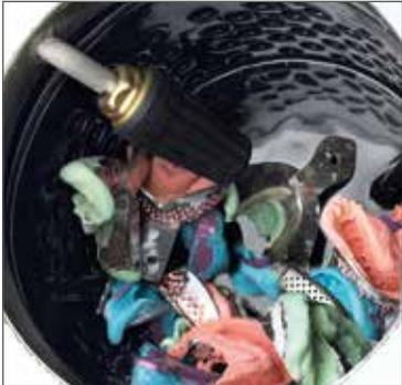
Die Trommel hat eine Kapazität von 25 Abformlöffeln oder 50 Artikulatorplatten
