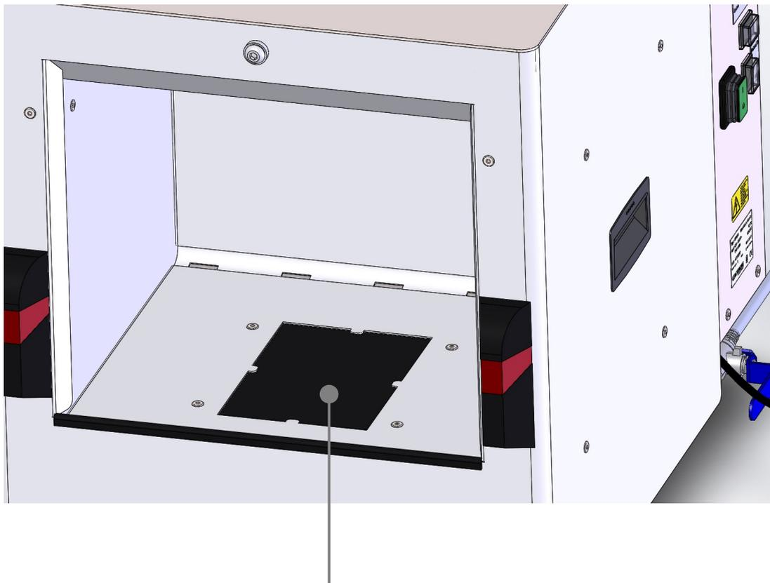
Filterelemente (4 Stück) – Bodenfilter (Arbeitsraum)
